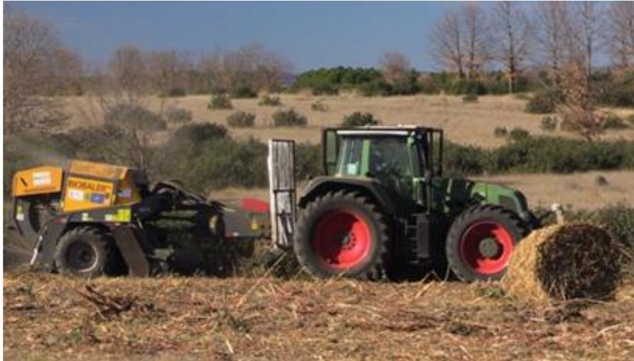
← Derecha, modelo acoplado a toma de fuerza de tractor ANDERSON BIOBALER WB 55
